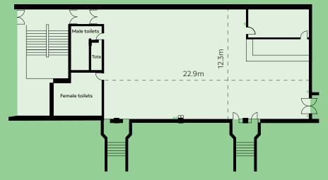
POWER - 5 X 13A DOUBLE SOCKETS - NO HEAVY POWER 1 X PRESENTATION PROJECTOR - 1 X AMP WITH CEILING SPEAKERS A/V - HDMI (VIDEO) & XLR (AUDIO) INPUT UNDER MAIN PRESENTATION SCREEN CELING HEIGHT 3·12M
